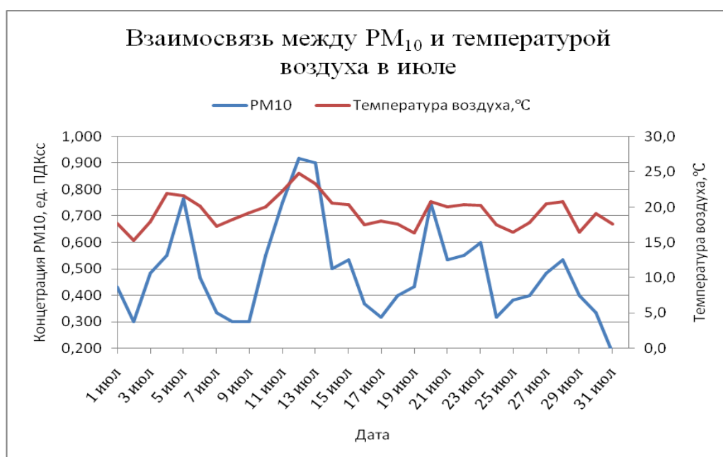
Рисунок 3.14 – График распределения концентрации \text{PM}_{10} и температуры воздуха в июле
