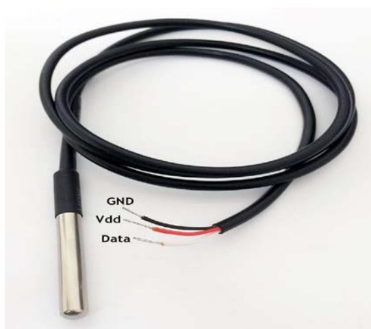
Рисунок 3.20 Цифровой датчик температуры DS18B20 с разметкой сигнальных проводов
