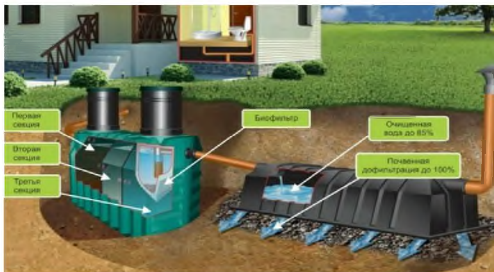
Рисунок 3.11 – Схема глубокой биологической очистки сточных вод в септике с различными фильтрационными устройствами
