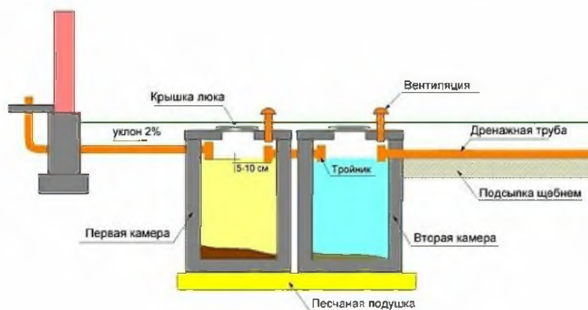
Схема переливного септика из бетонных колец
