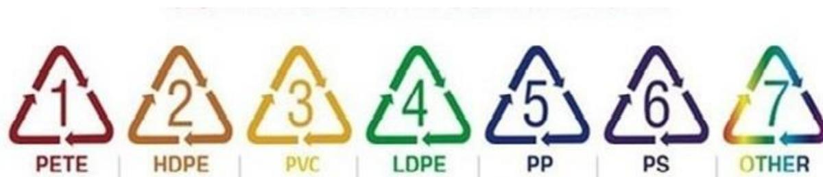
Рисунок 7 – Виды пластмасс и маркировка пластика [18]
