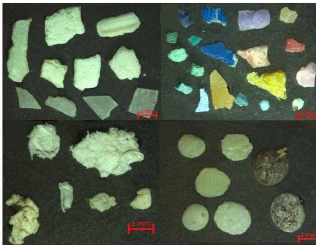
Рисунок 8 – Частицы микропластика в увеличительном стекле микроскопа
