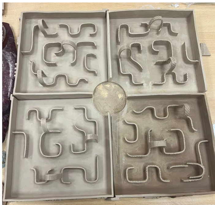
Приложение Б9. Сборка блоков перед первичным обжигом.
