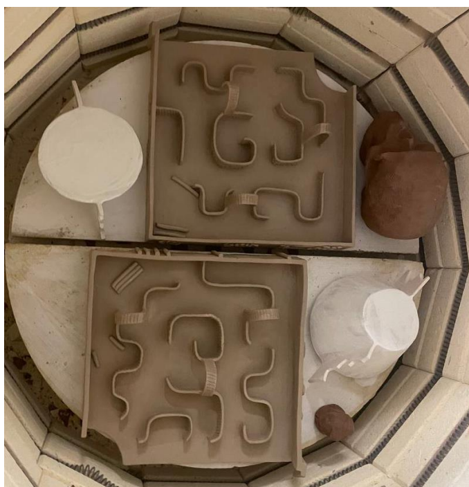
Приложение Б10. Загрузка блоков в муфельную печь.
