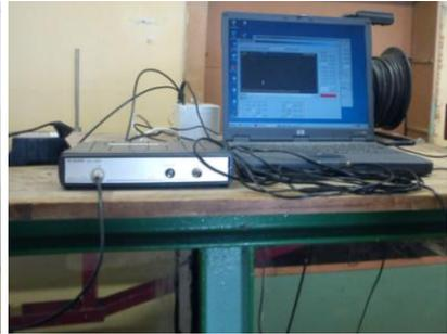
Рис. 2.15. Фрактальная диагностика безнапорного движения в лаборатории водных исследований РГГМУ: *а* – общий вид экспериментальной установки (на снимке аспирант Поташко Е. А.); *б* – микровертушка с осциллографом и компьютером.
