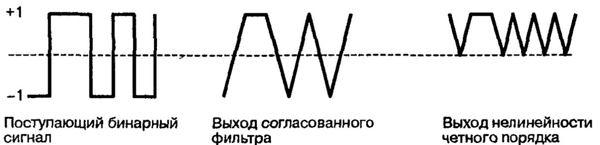
Рисунок 2. Иллюстрация процессов, происходящих в разомкнутом битовом синхронизаторе.
