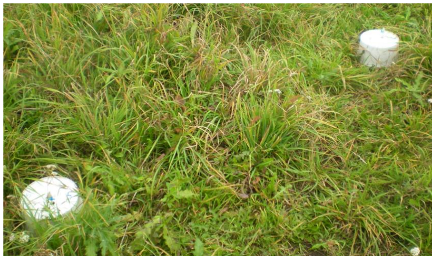
Рисунок 5 – Камеры, установленные на почву для накопления воздуха за определенное время
