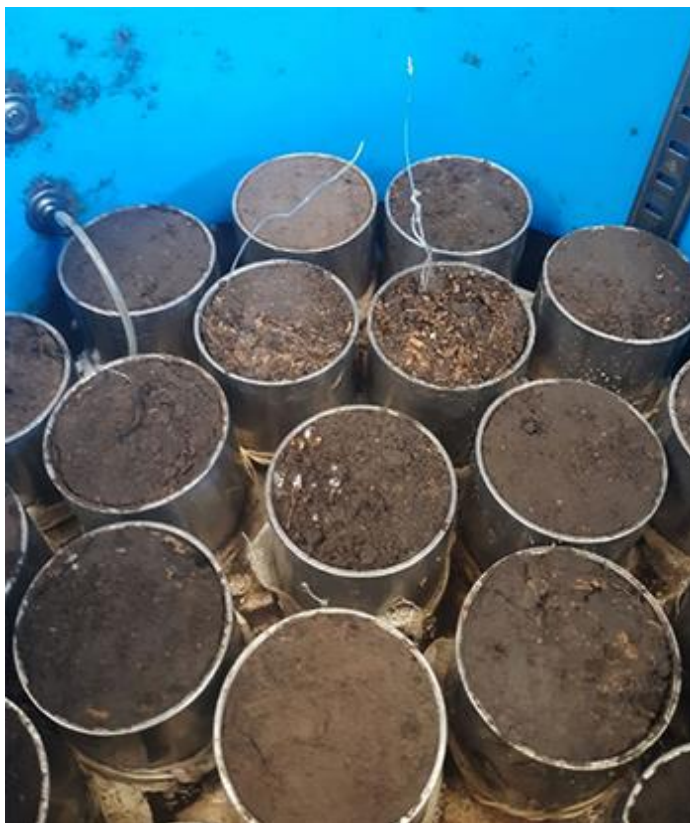
Рисунок 4 – Отбор почвенных образцов на плотность сложения при помощи цилиндров.
