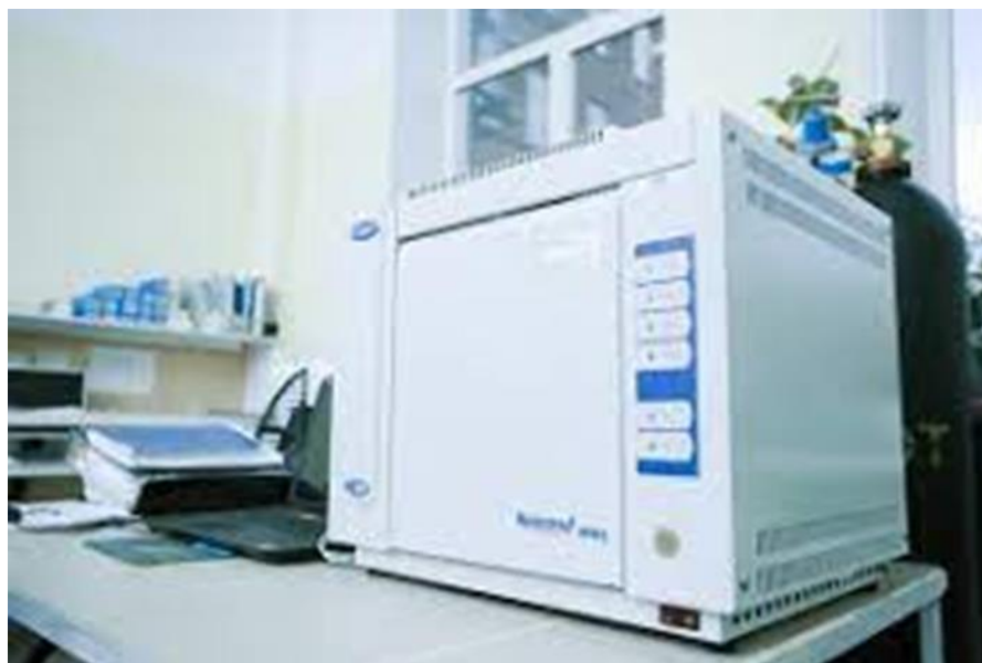
Рисунок 6 – Вид на газовый хроматограф Кристаллюкс 4000 для определения эмиссии \text{CO}_2 и \text{N}_2\text{O} в образцах воздуха из почв
