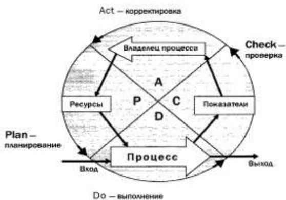
Рисунок 14 – Наложение функций процесса на цикл PDCA [6]
