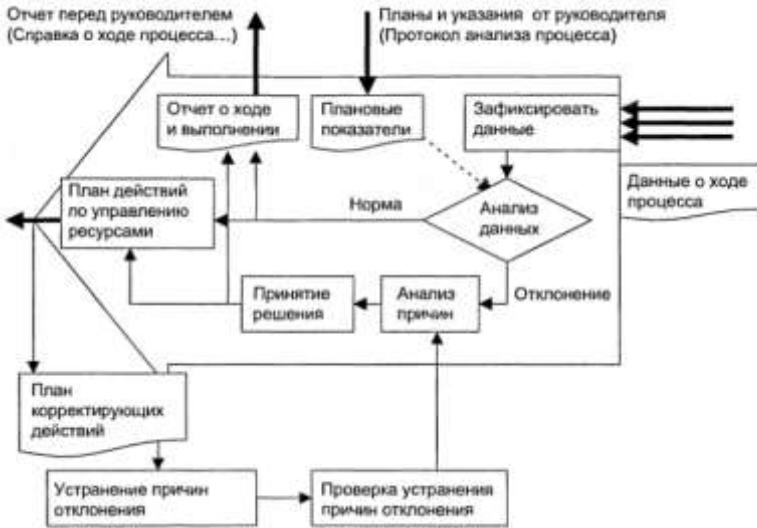
Рисунок 17 – Алгоритм действий владельца процесса по управлению процессом [6]
