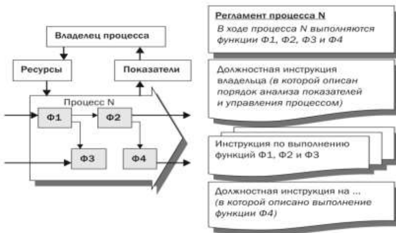
Рисунок 21 – Структура документации простейшего процесса [19]
