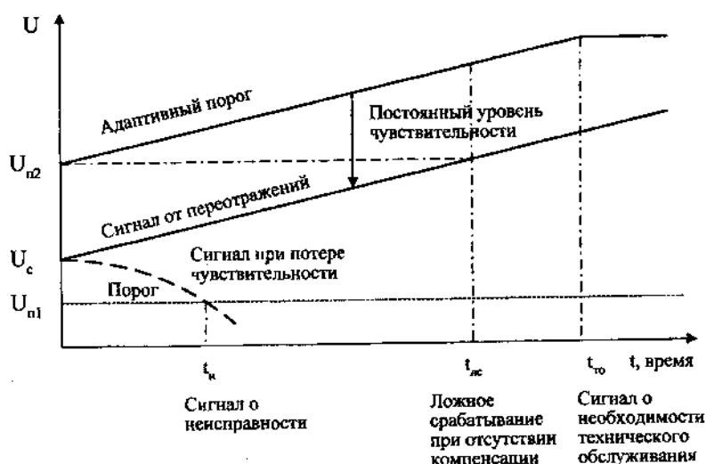
рис. 7. Возможные изменения контролируемого сигнала 1L для дымового извещателя с автоматической калибровкой и сигнализацией технического обслуживания.
