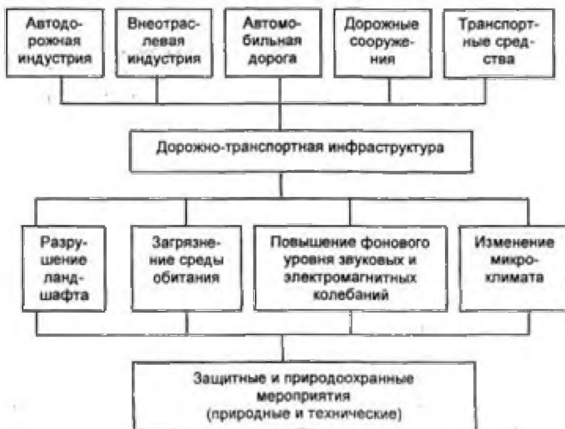
Рисунок 3.14 – Схема взаимодействия дорожно-транспортной инфраструктуры с окружающей средой [27]
