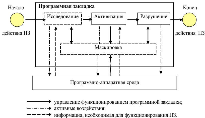
Рис. 3.4. Схема функционирования программной закладки
