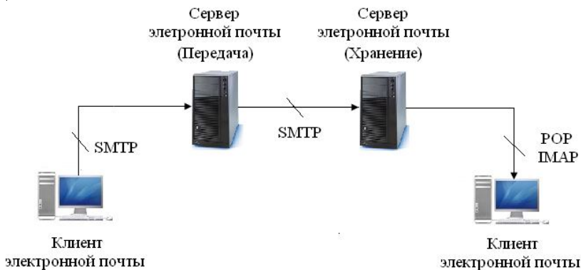
Рис. 6.1. Место протоколов SMTP, POP, IMAP в службе электронной почты
