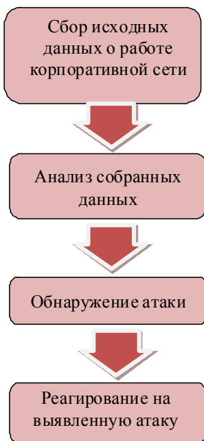
Рис. 5.1. Схема процесса обнаружения атаки
