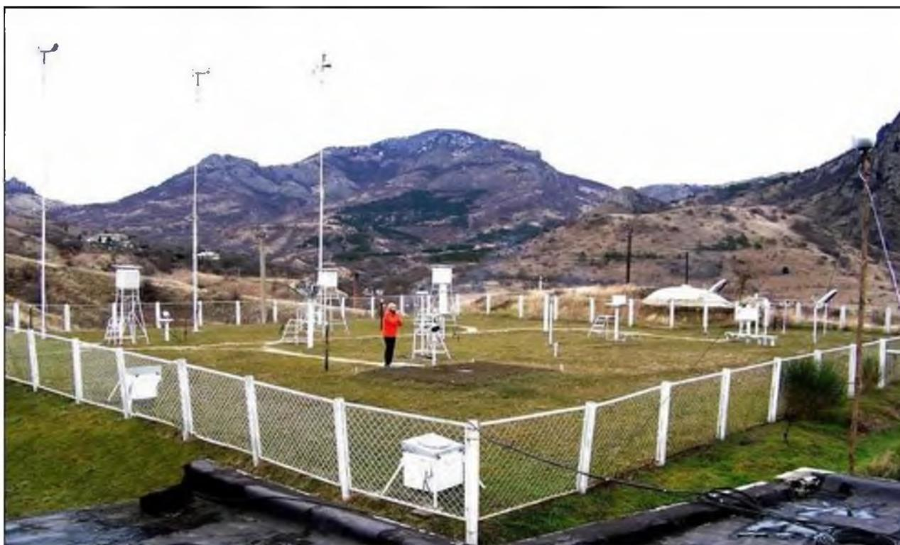
Рисунок 1.6 – Общий вид типовой метеорологической площадки
