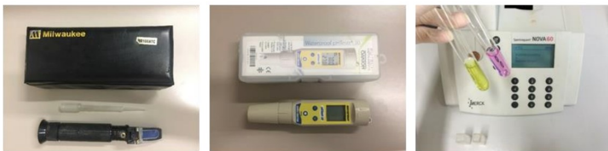
Рисунок 20. Рефрактометр, рН-метр и спектрофотометр для проверки параметров воды
