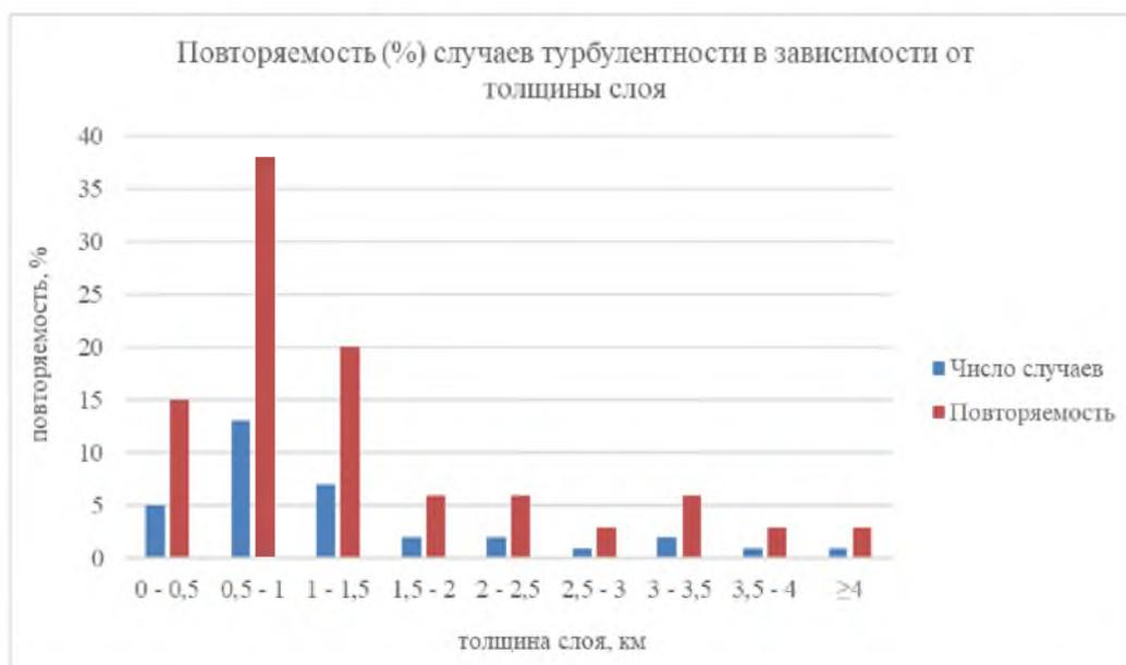
Рисунок 3.6 – Повторяемость случаев турбулентности в зависимости от толщины слоя за период 2019-2023 гг, %
