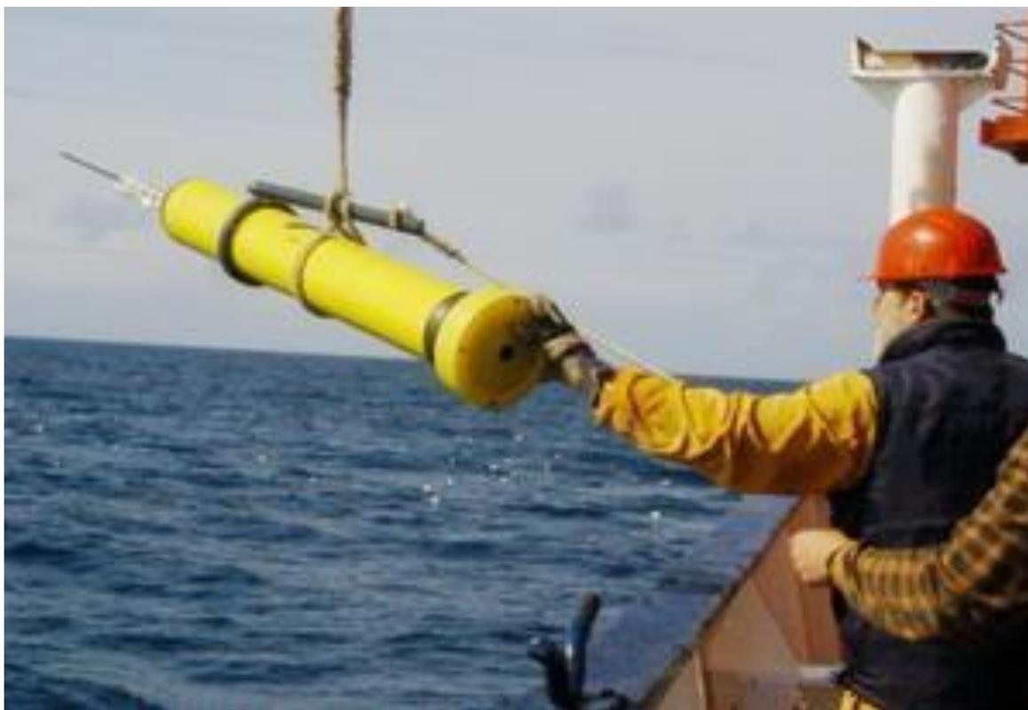
**Рисунок 1.2** – Развертывание буя системы «Argo» с научно-исследовательского судна.
