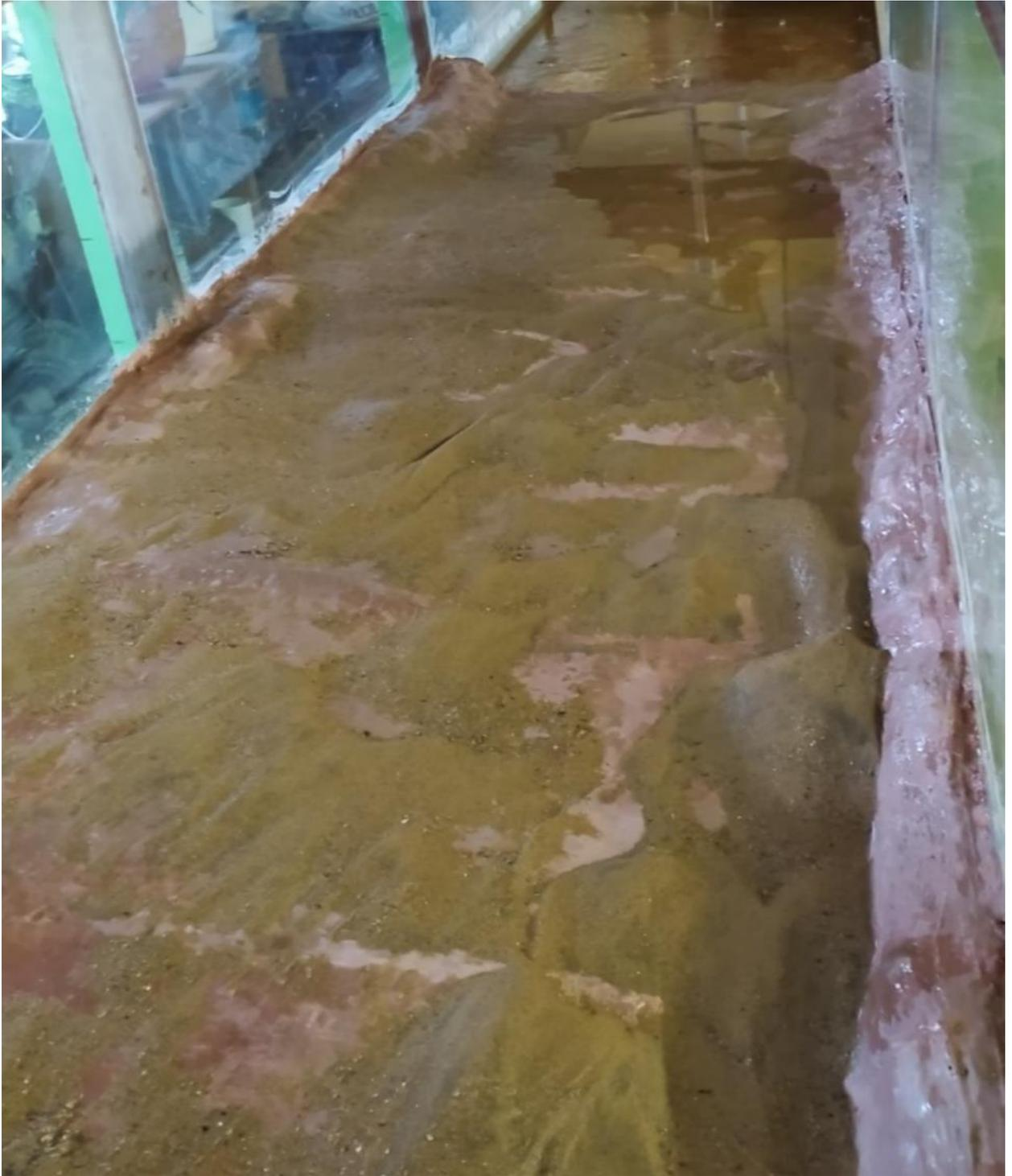
Рисунок 3.2—Цементная модель на песчаной подушке
