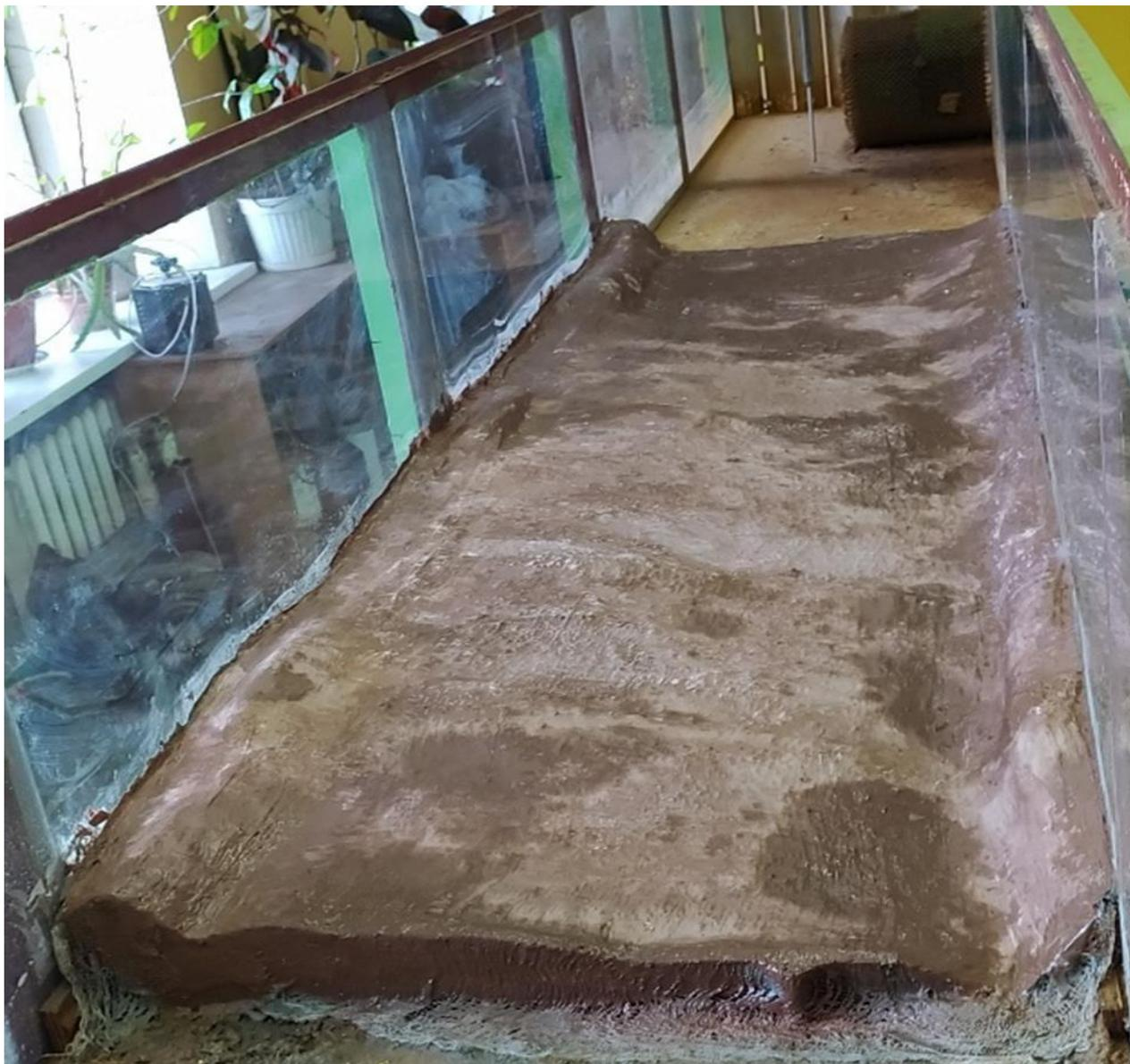
Рисунок 3.1 – Цементная модель на песчаной подушке.
