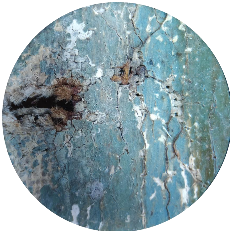
Ил. 8 Общий вид рваного прорыва.
