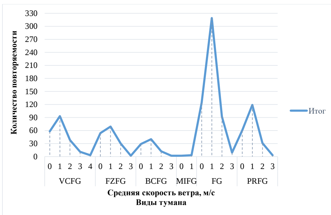
Рисунок 4.24 – Повторяемость средней скорости ветра при разных видах тумана в аэропорту Сокол за период 2019-2023 гг.
