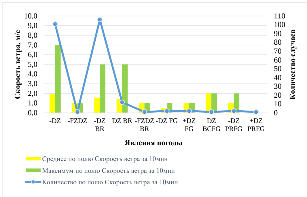
Рисунок 4.33 – Повторяемость скоростей ветра в аэропорту Сокол при мороси
