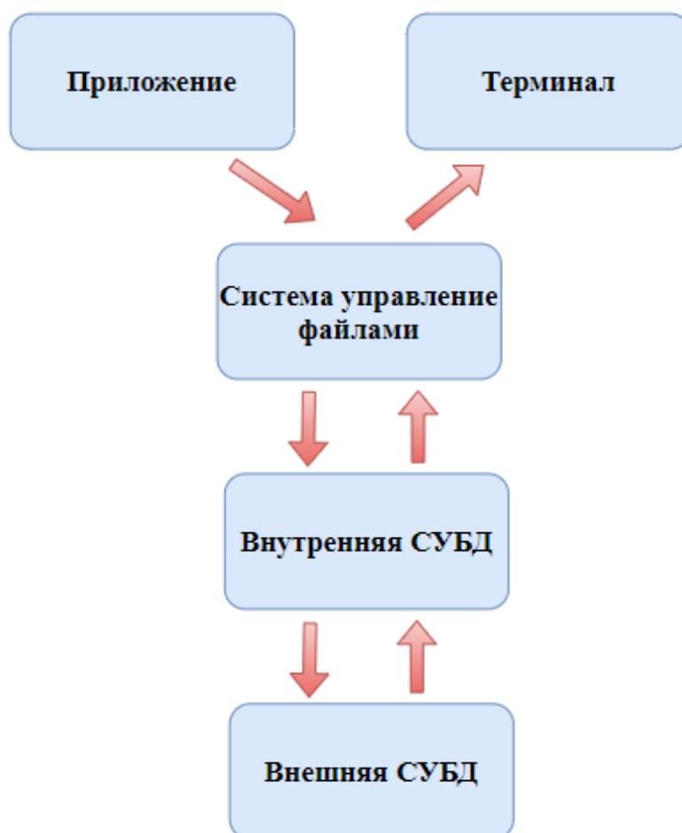
Рисунок 17 – Принцип функционирования СУБД
