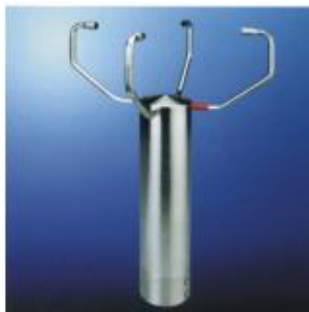
Рисунок 2.6 – Внешний вид акустического анемометра
