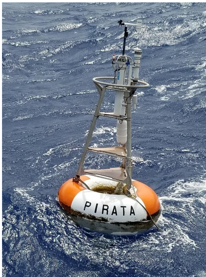
Рисунок 4.1 – Буйковая метеорологическая станция PIRATA (США, Франция, Бразилия)
