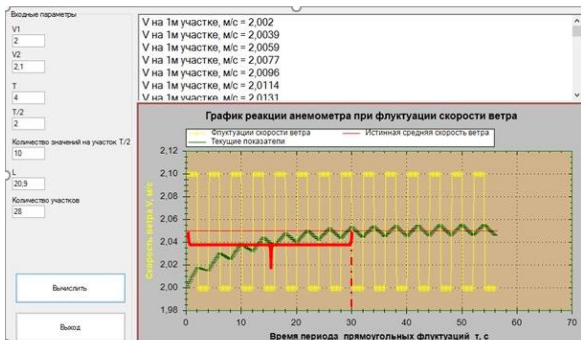
Рисунок 3.1 – Автоматизированный расчёт реакции анемометра на флуктуации скорости ветра с построением графика
