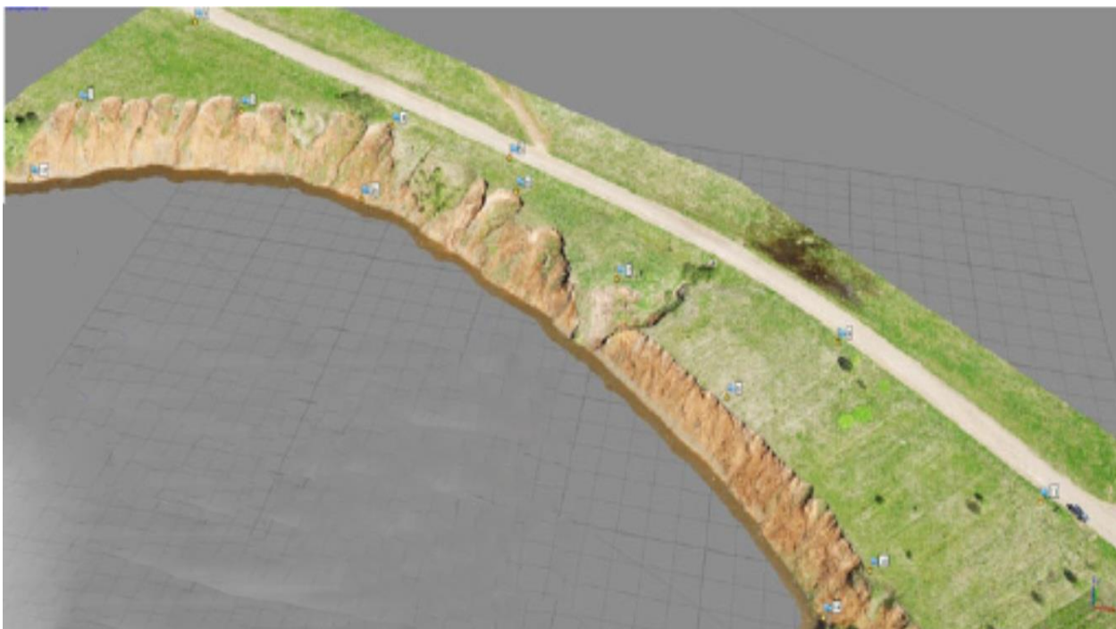
Рисунок 2.13 – Плотное облако точек, полученное с БПЛА
