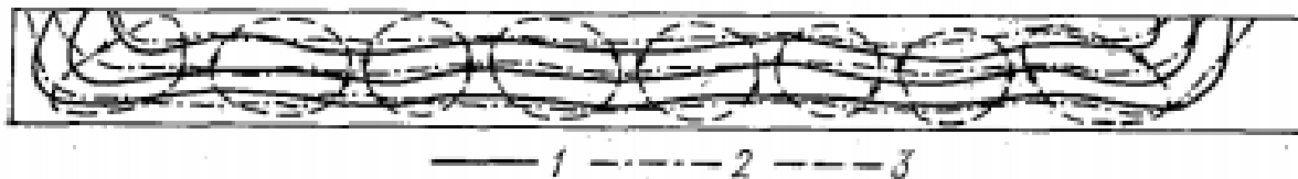
Рис. 2.3.1. Поля скоростей в открытом потоке прямоугольного сечения ( 2B/H \gg 10 ).
