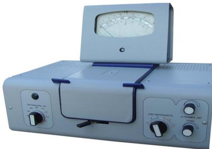
**Рис.3. Колориметр фотоэлектрический концентрационный КФК-2[27]**
