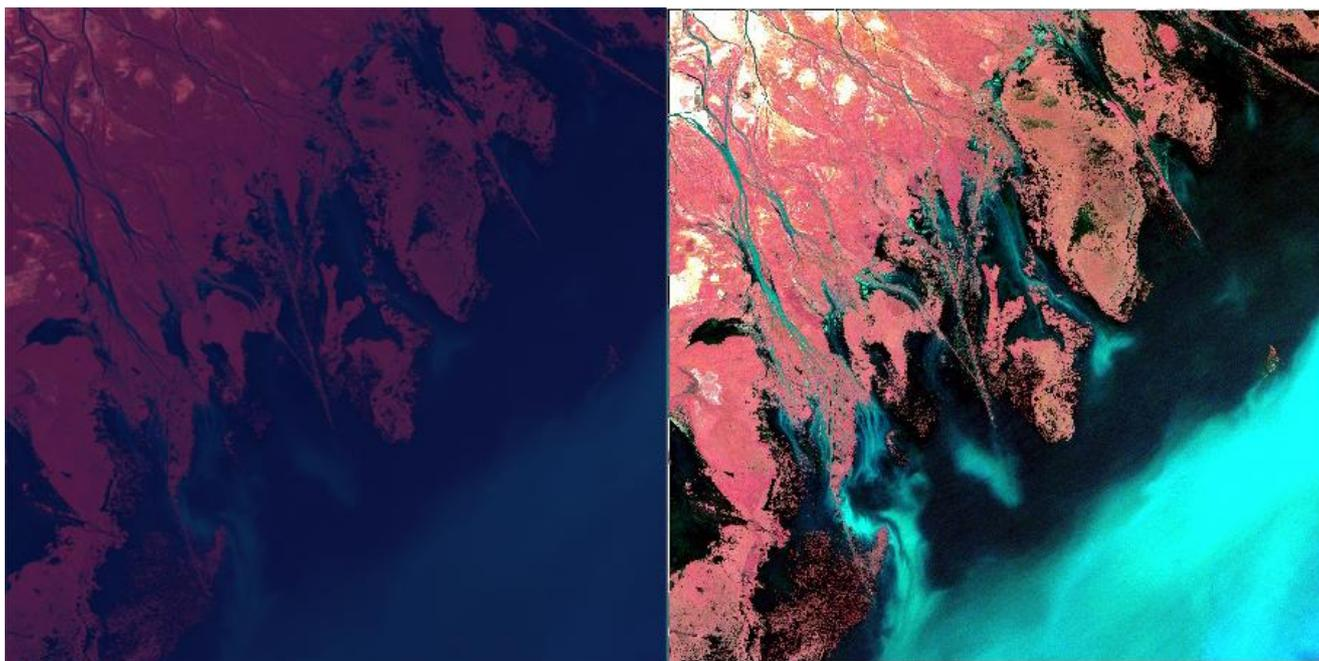
Рисунок 2 – композитное изображение «5,3,1» (слева); композитное изображение «5,3,1» с автолинейным контрастированием (справа) июль 2009
