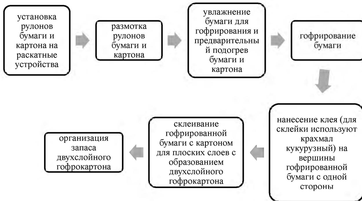
Рисунок 2.12 – Технологический процесс производства гофрокартона
