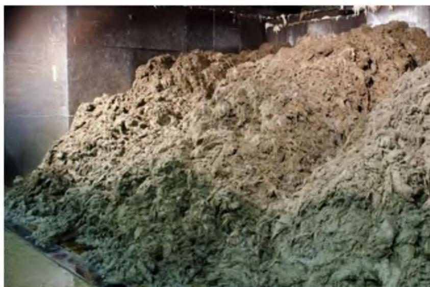
Рисунок 2.5 – Химическая термомеханическая масса
