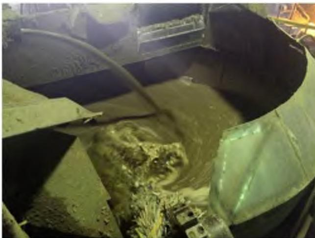
Рисунок 2.7 – Роспуск макулатуры в гидроразбивателе
