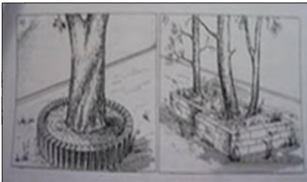
Рисунок 3.4 — Способы сохранения деревьев на участках срезки грунта: а) с помощью деревянных брусков; б) с помощью камней, кирпичей
