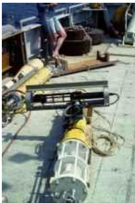
Рисунок 2.27 – Векторный усредняющий измеритель тока (VASM) трансмиссометром Sea Tech, установленным горизонтально в защитном кронштейне [31]
