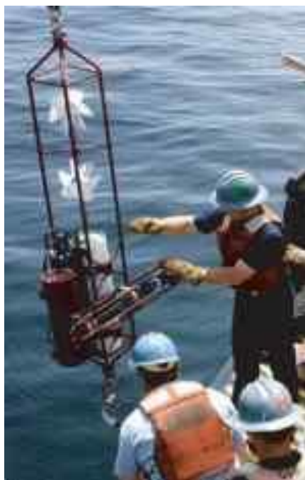
Рисунок 2.28 – Векторный измеритель тока (VMCM) разворачивается как часть подводной швартовки
