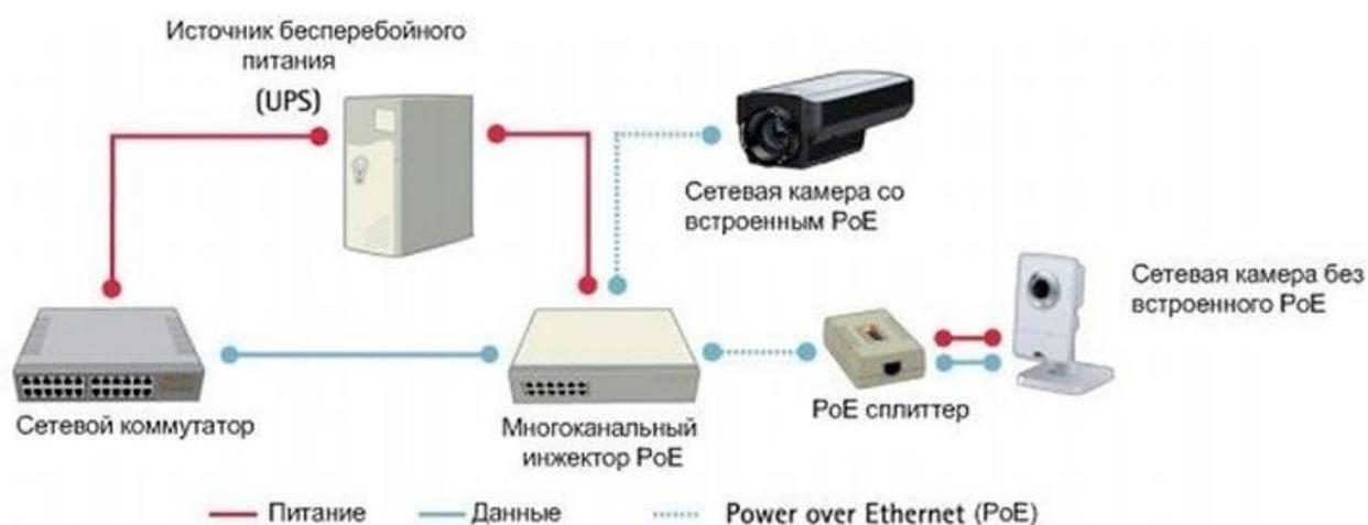
Рисунок 20 Схема подключения Видеонаблюдения с PoE
