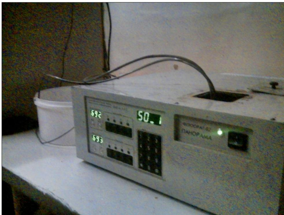
Рисунок 2.2 – Внешний вид спектрофлюориметра «Флюорат-02-Панорама»
