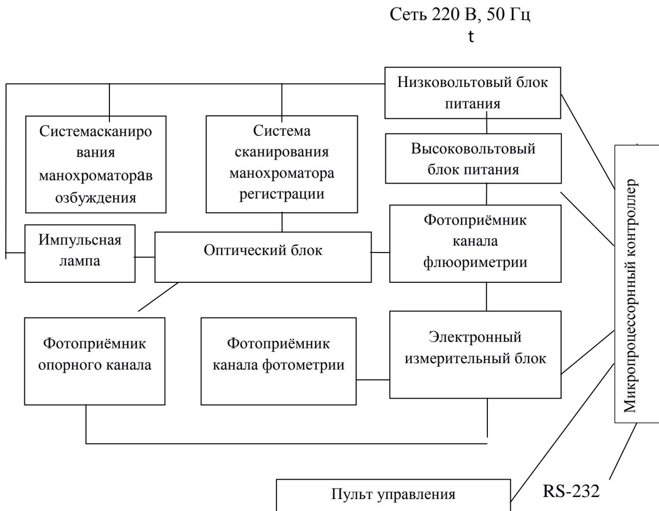
Рисунок 2.1 – Структурная схема анализатора «Флюорат-02-Панорама»
