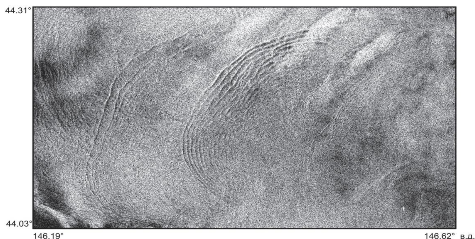
Рисунок 12 Пример отображения волновых пакетов на спутниковом радиолокационном изображении Sentinel-1A [17]
