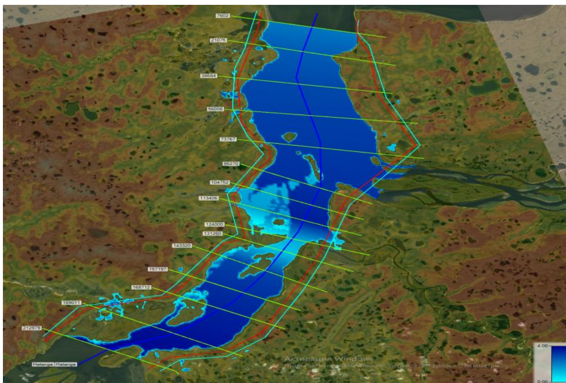
Рисунок 4.10 – План глубин и заполнения при расходе 9000 \text{ м}^3/\text{с} .
