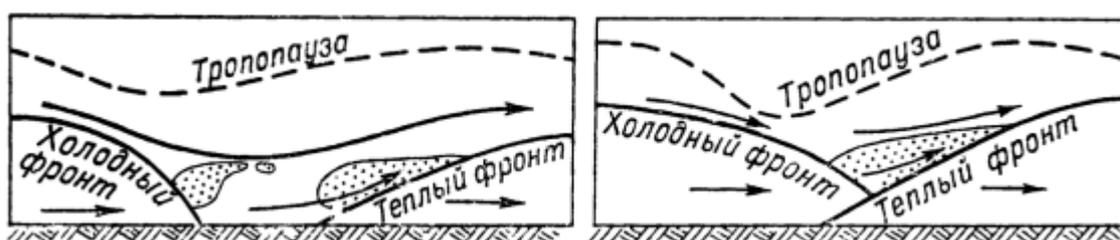
Рисунок 1.2 - Образование воронки тропопаузы над циклоном
