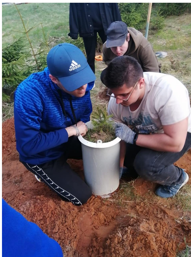
Рисунок 2.3 – Извлечение почвенного монолита студентами РГГМУ на базе практик РГГМУ в д. Даймище
