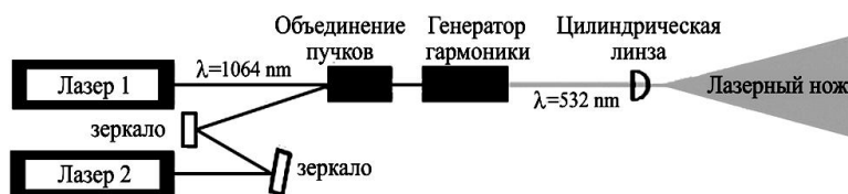
Рис. 2.2 Схема излучателя для метода PIV-диагностики [7]
