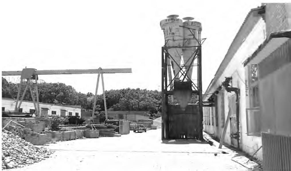
Рисунок 20 — Бункер циклона на открытой площадке РСО
