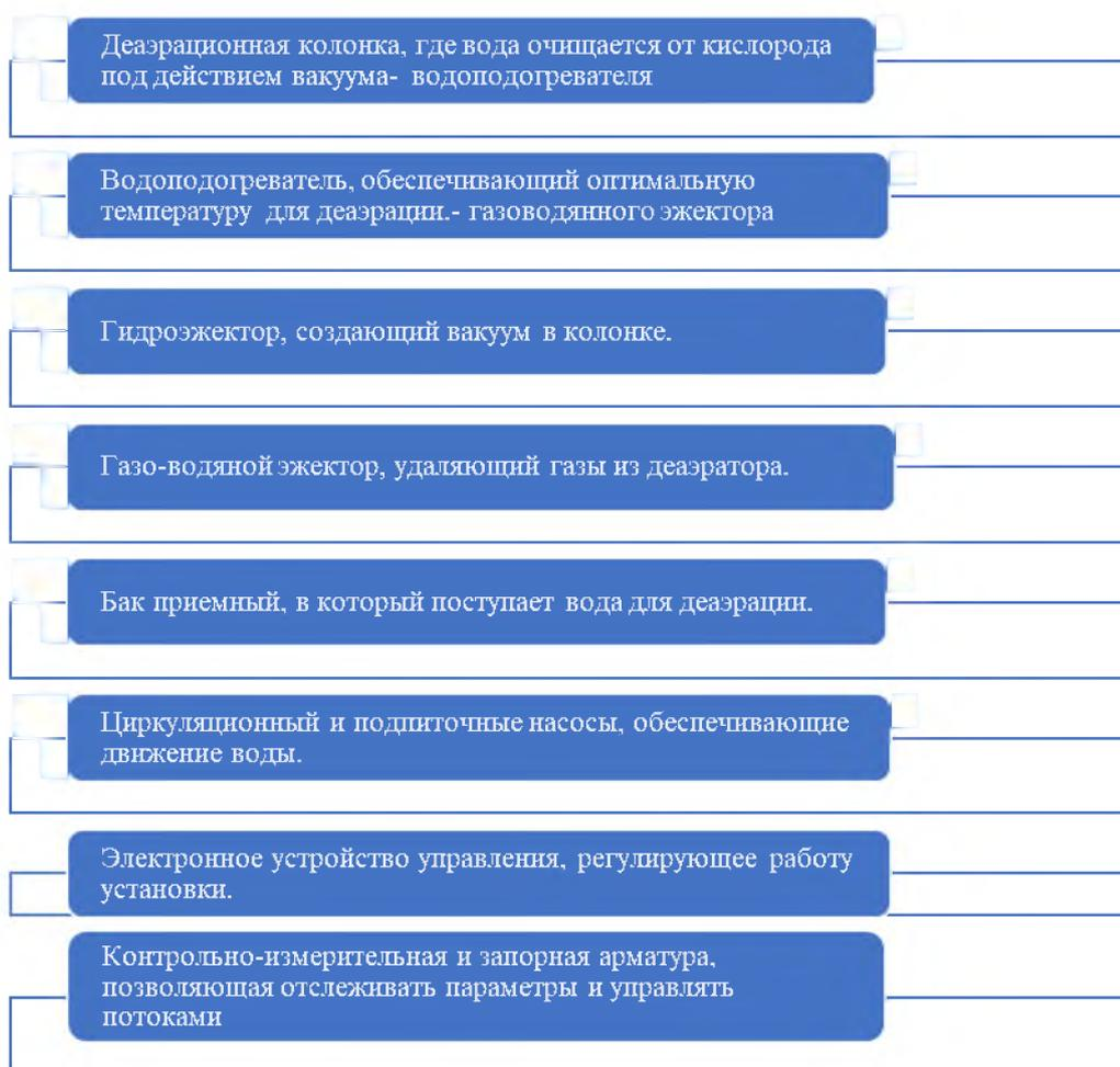
Рисунок 12 — Подпиточная установка (ВДПУ-5А)
