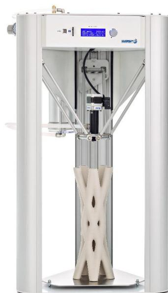
Приложение Б7. 3D-принтер «WASP Delta 2040 Clay», на котором печатались светильники
