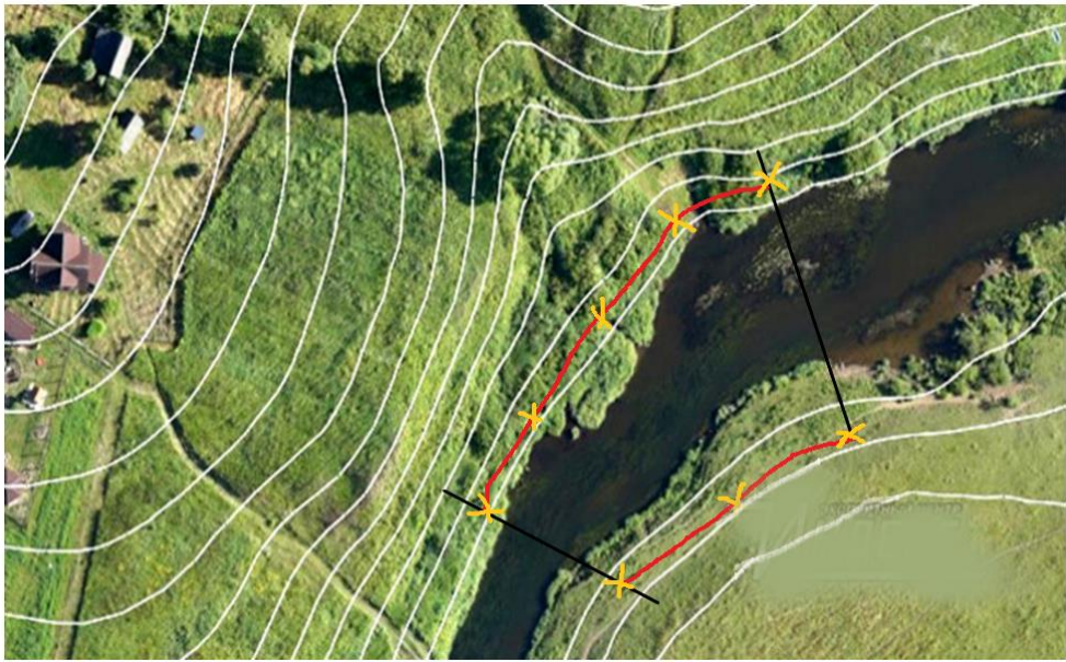
Рисунок 16 – Нанесение береговой линии на топографическую основу
