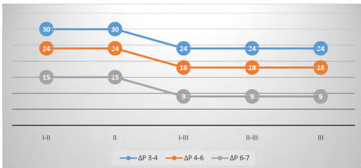
Рисунок 2.7 – Максимальное время, когда сильная зыбь подойдет к рассматриваемому району при разных значениях \Delta P
