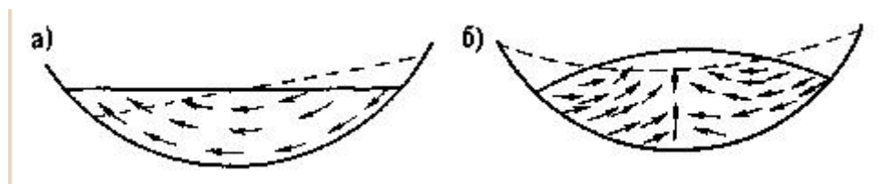
Рисунок 1.2 - Одноузловая сейша (а) и двухузловая сейша (б)
