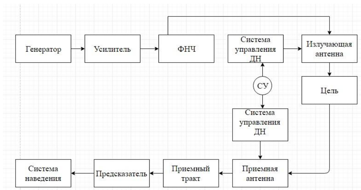
Рис. 2.1 - Структурная схема устройства системы наведения гидроакустического канала.
