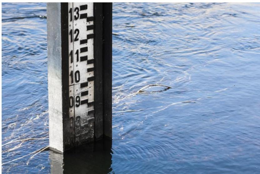
Рисунок 1.6 – Гидрологический пост. Постоянная рейка
