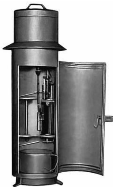
Рис. 5. Плувиограф П-2 [20, с. 19]
