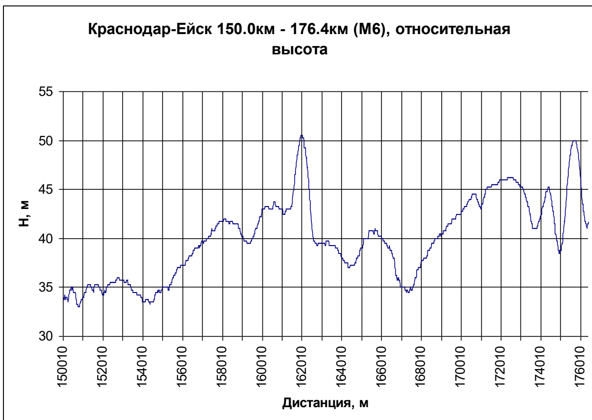
Рис. 4.19 График изменения относительной высоты вдоль шестой трассы термокартирования: от 149 км + 930 м до 176 км + 080 м
