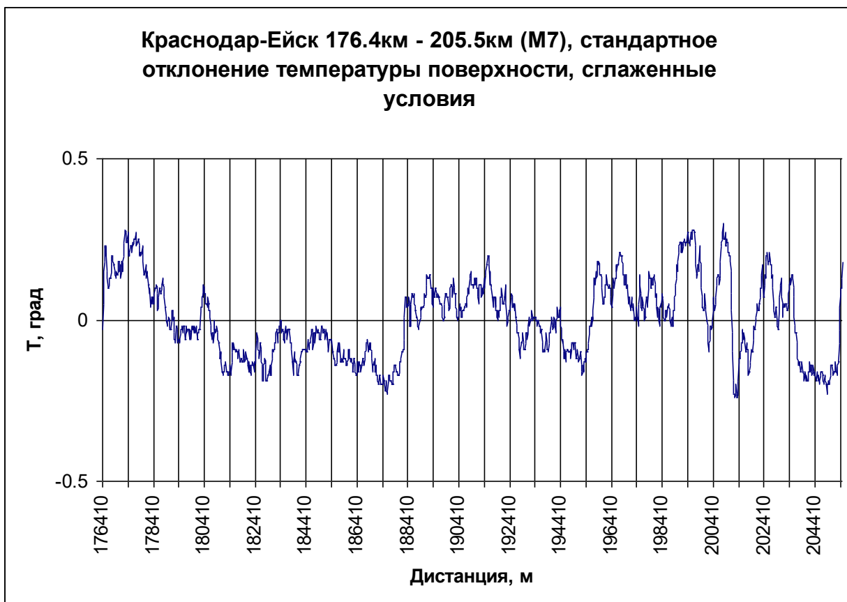
Рис. 4.23 График значений СКО, полученный путем обработки 5 «прогонов» по седьмому участку трассы: от 176 км + 080 м до 205 км + 210 м
