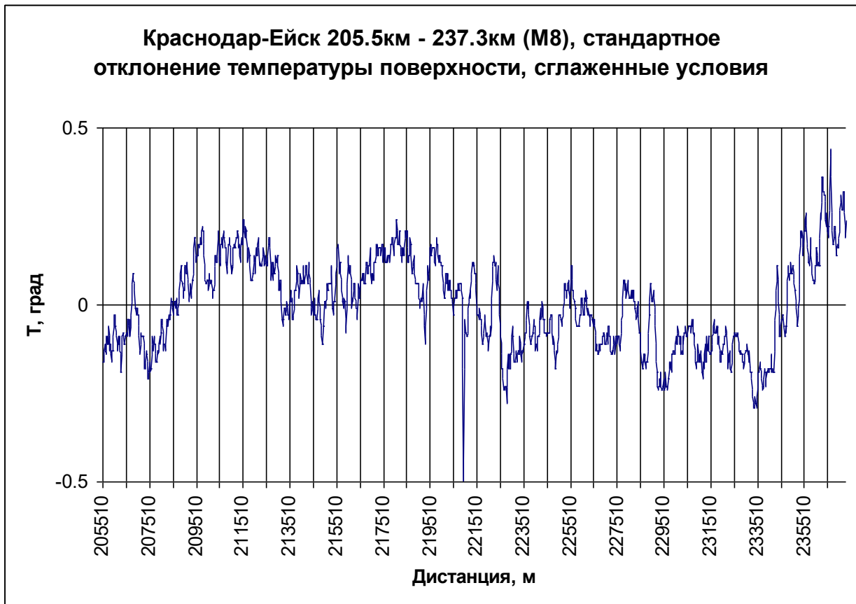
Рис. 4.24 График значений СКО, полученный путем обработки 5 «прогонов» по восьмому участку трассы: от 205 км + 210 м до 236 км + 920 м
