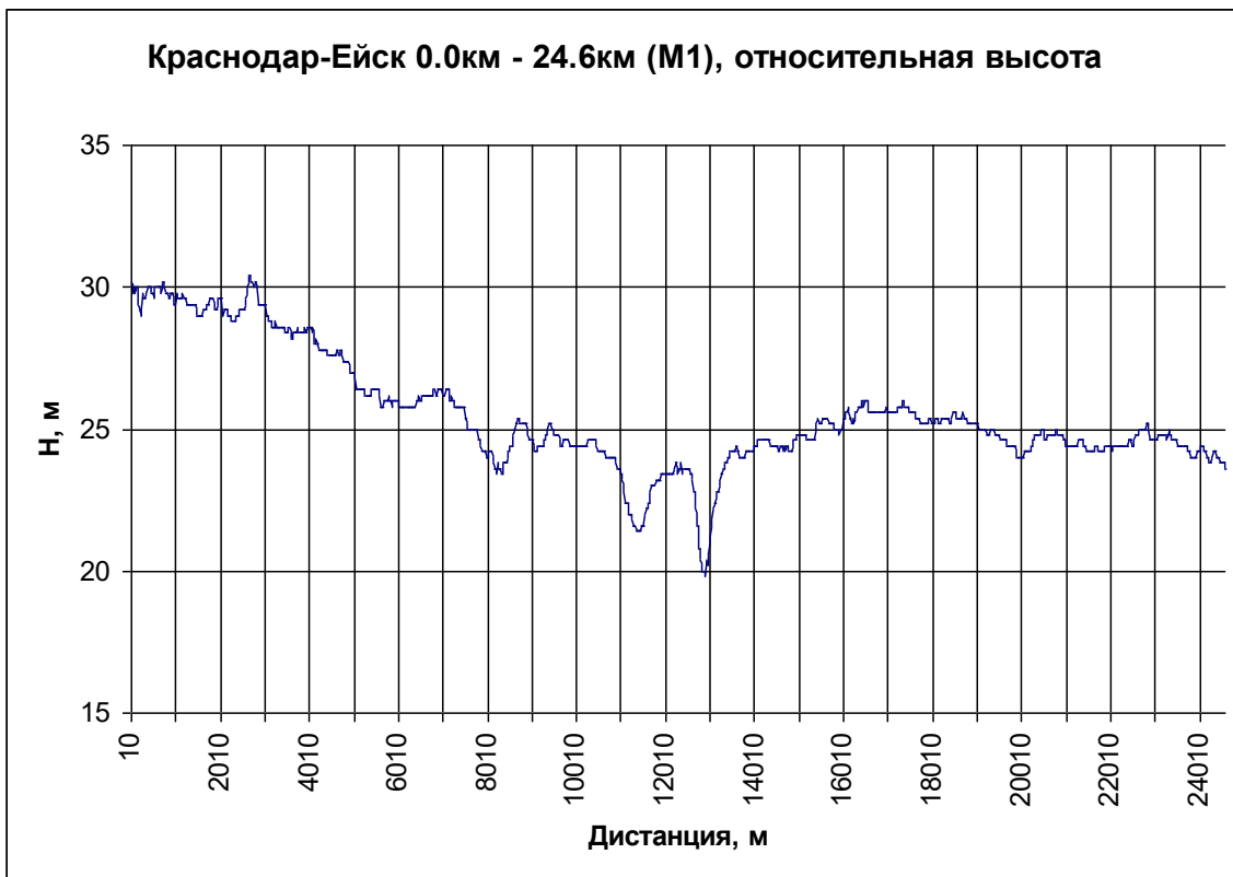
Рис. 4.9 График изменения относительной высоты вдоль первой трассы термокартирования: от 0 км + 000 м до 24 км + 580 м
