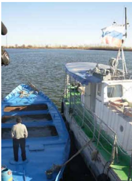
Рисунок 7 - Живорыбное судно «прорезь».
