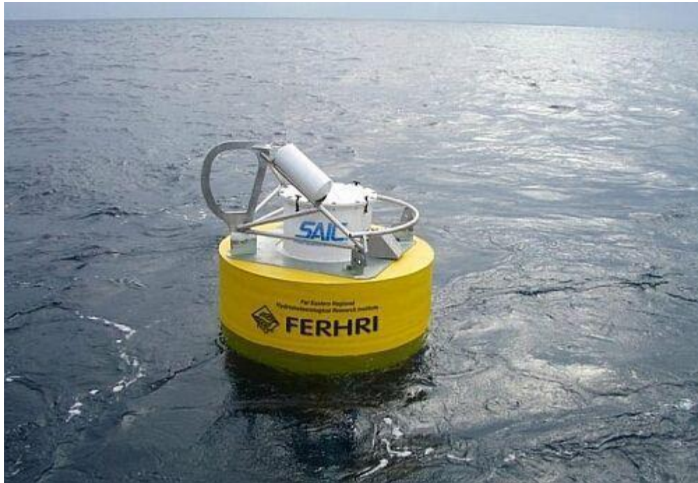
Рисунок 1.2 – Фотоизображение буйковой метеостанции по предупреждению цунами
