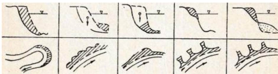
Рис. 5. Формы подмыва вогнутых берегов излучин в поперечном сечении (сверху) и в плане (снизу).
