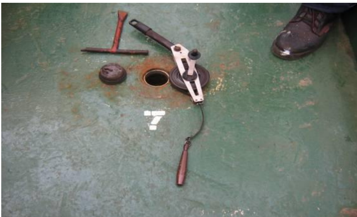
Рис.4. Специальные замерные отверстия, используемые для ручного контроля уровня балластной воды в танках
