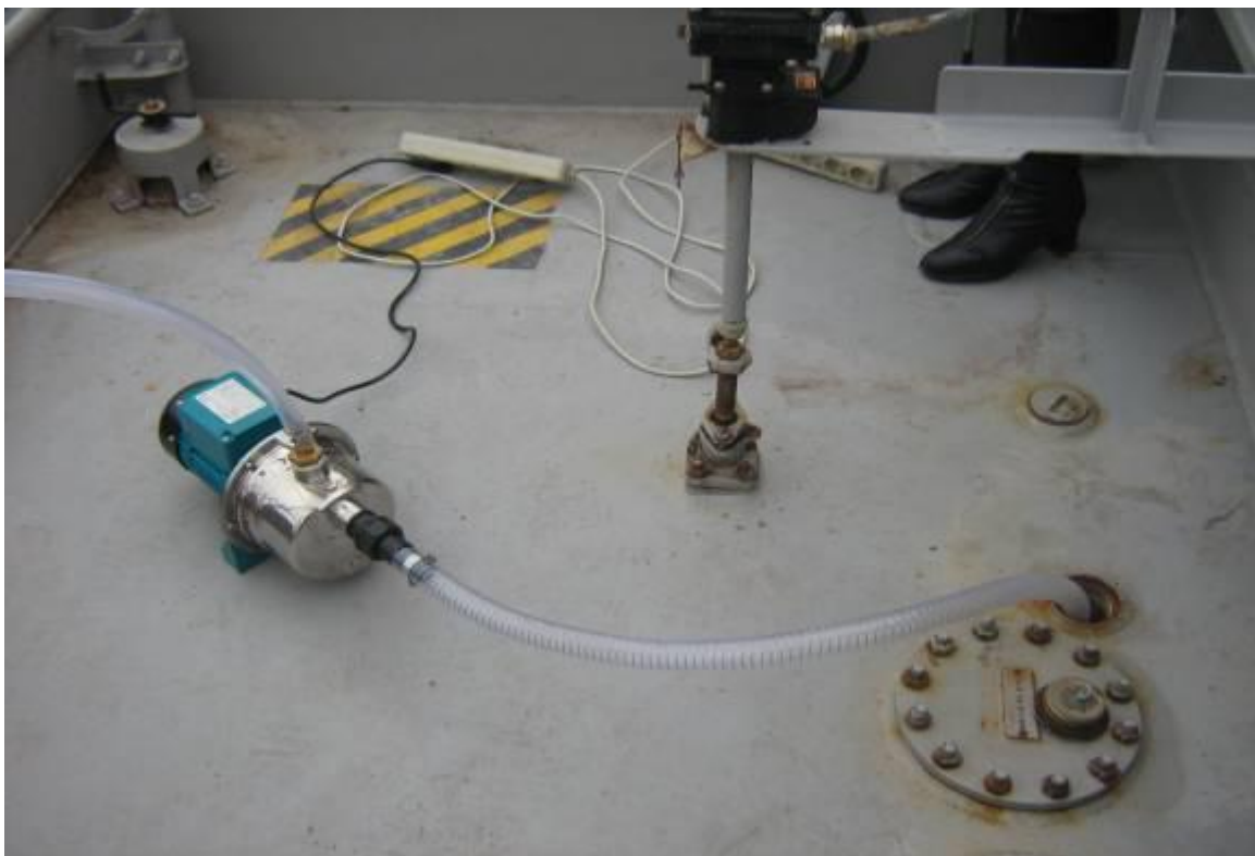
Рис.5. Отбор проб воды с помощью поверхностного насоса
