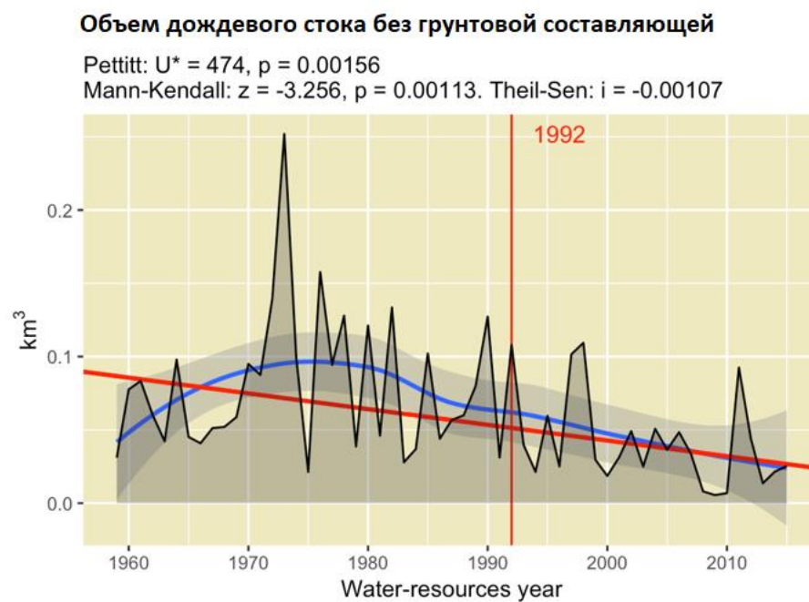
Рис.2.35.Объем дождевого стока по гидропосту р.Сосна- г. Елец без грунтовой составляющей
