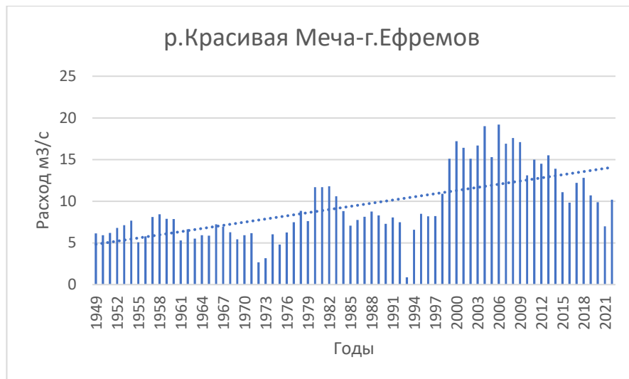
Рисунок 2.4.График распределения минимального расхода воды на гидропосту р.Красивая Меча-г.Ефремов, выделяется тренд на повышение расходов, прослеживается неоднородность.
