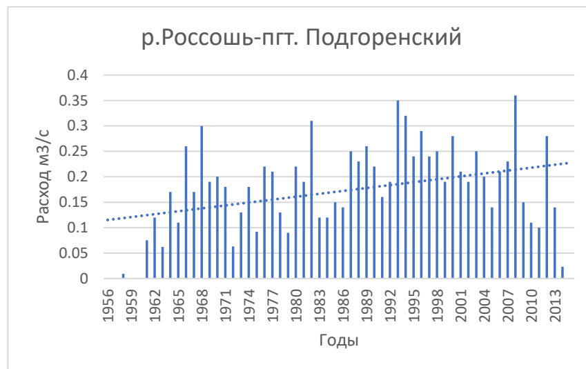
Рисунок 2.5.График распределения минимального расхода воды на гидропосту р.Россошь-пгт. Подгоренский, выделяется тренд на повышение расходов, прослеживается неоднородность.
