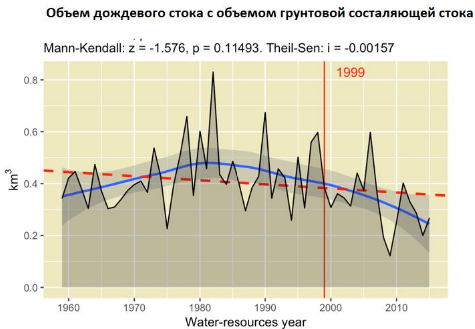
Рис.2.36.Объем дождевого стока вместе грунтовой составляющей по гидропосту р.Сосна- г. Елец
