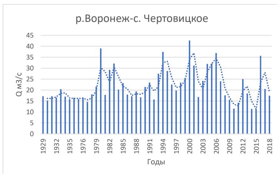
Рисунок 2.2 График распределения минимального расхода воды на гидропосту р.Воронеж-с.Чертовицкое ряд без видимых аномалий, однороден по дисперсии.
