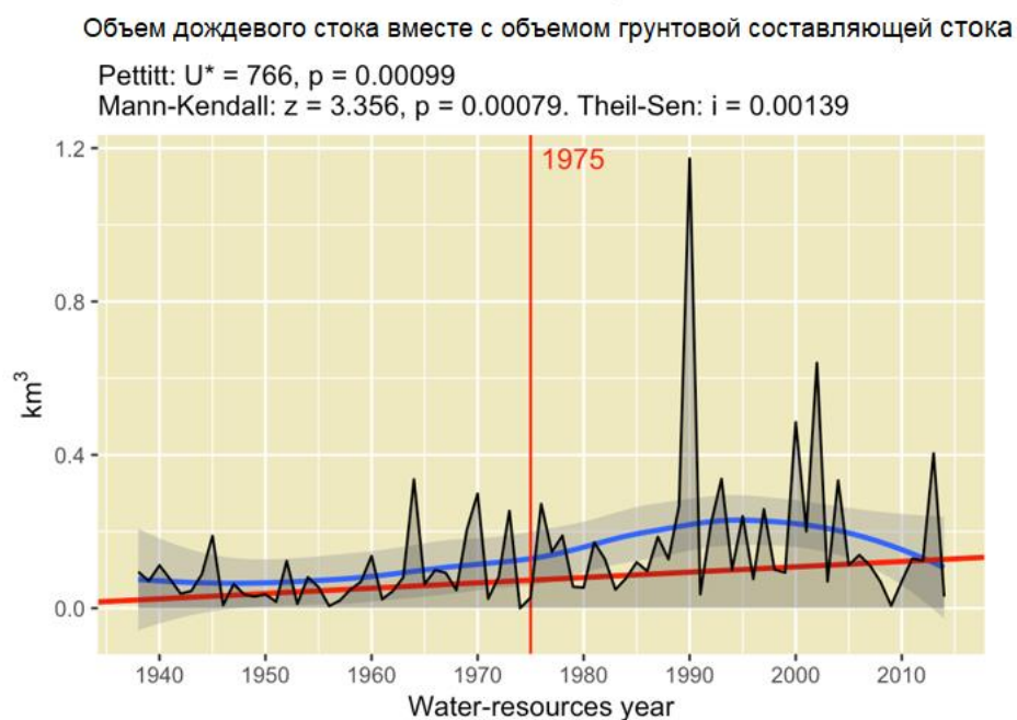
Рис.2.23.Объем дождевого стока вместе грунтовой составляющей по гидропосту р.Хопер- х. Бесплемяновский
