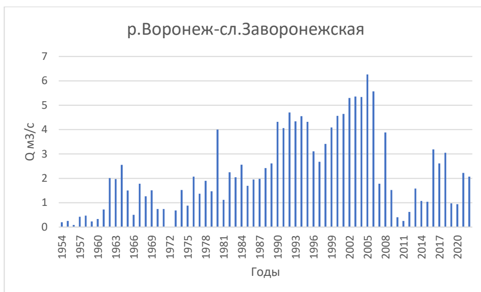
Рисунок 2.1.График распределения минимального расхода воды на гидропосту р.Воронеж-сл.Заворонежская прослеживается неоднородность по дисперсии.
