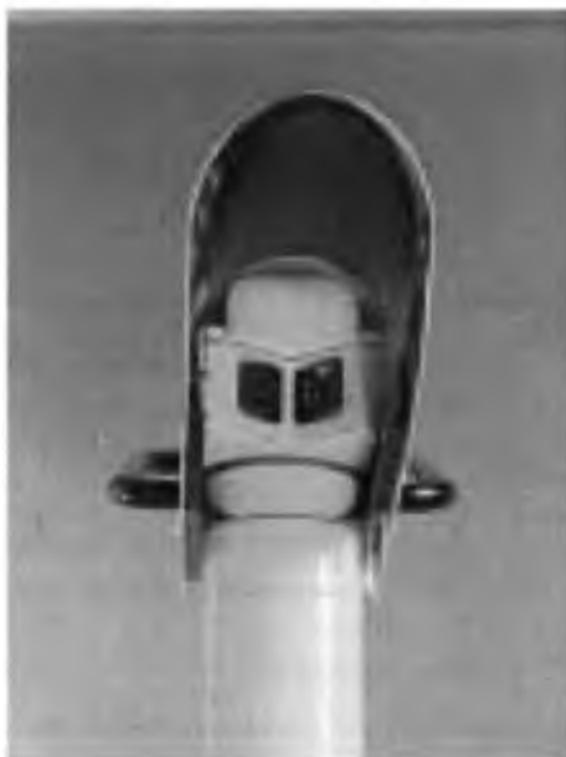
Рисунок 3.2 — Измерения видимости производятся через V-образное окно с поправкой на загрязненность
